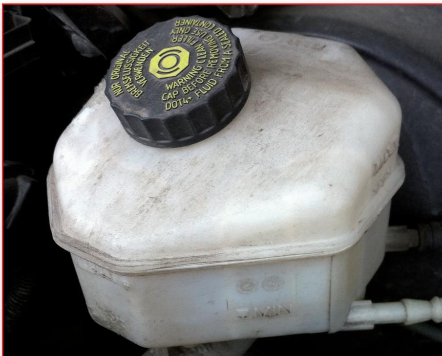
**Figura 1.** Depósito del líquido de frenos.
