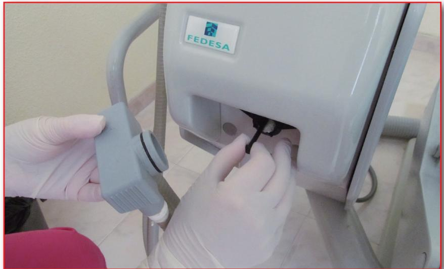
**Figura 27.** Desmontaje del filtro para su limpieza.
