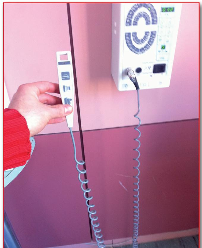
**Figura 18.** Mando con botón de exposición unido al panel de control por un cable extensible.
