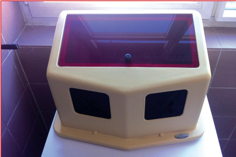
**Figura 48.** Caja oscura de revelado.
