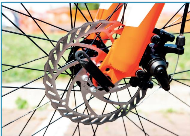
Figura 6. Ejemplo de sistema de freno de disco.
