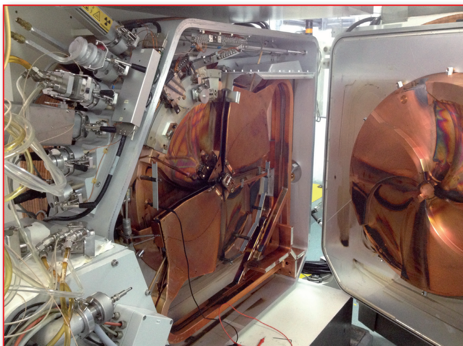
Figura 3. La imagen muestra un ciclotrón abierto para poder mostrar su estructura interna.
