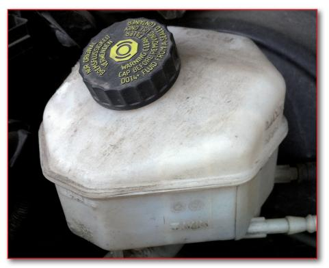
Figura 1. Depósito del líquido de frenos.
