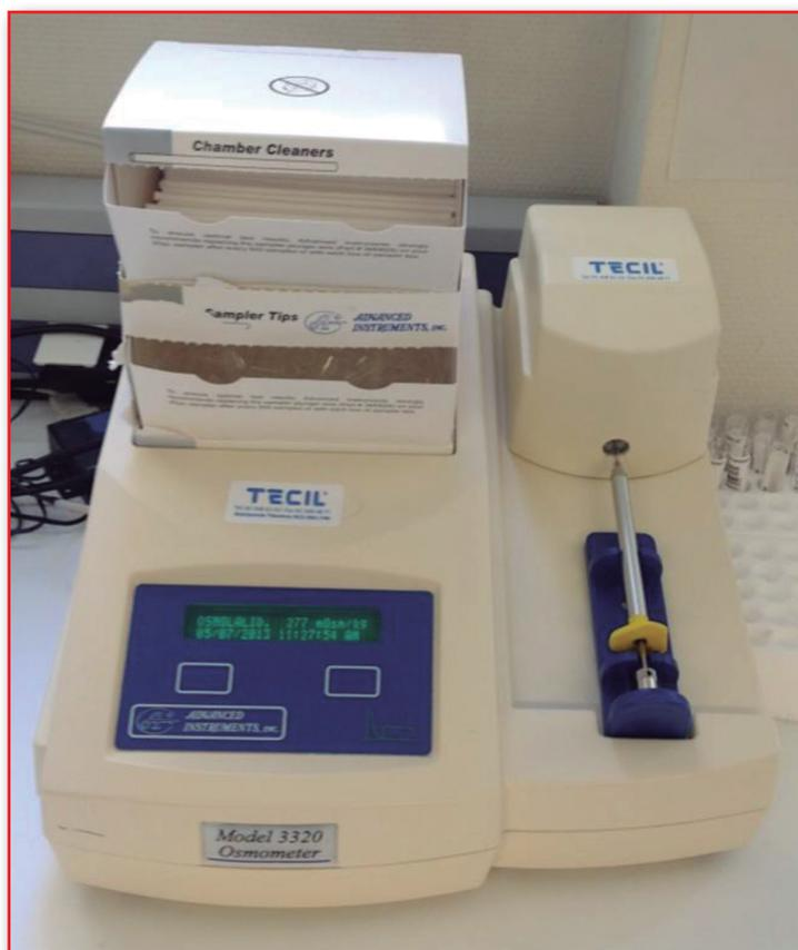
**Figura 44.** Fotografía de un osmómetro de descenso crioscópico.
