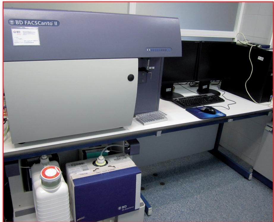
**Figura 22.** Ejemplo de citómetro de flujo con su conexión a un ordenador y doble pantalla.
