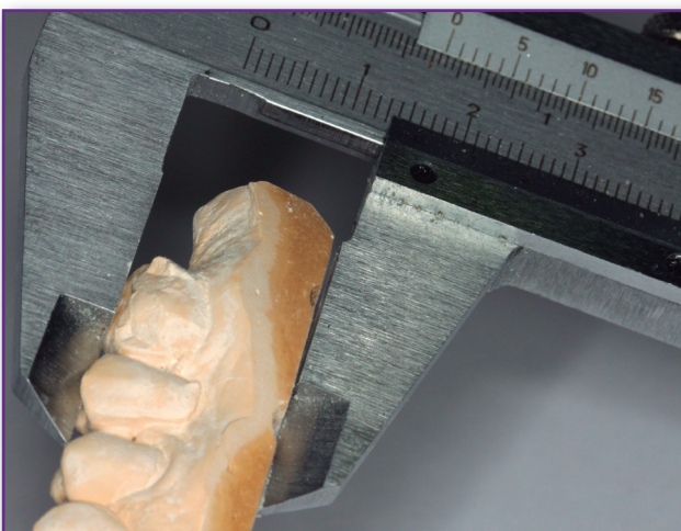
Figura 18. Control de la altura del modelo.
