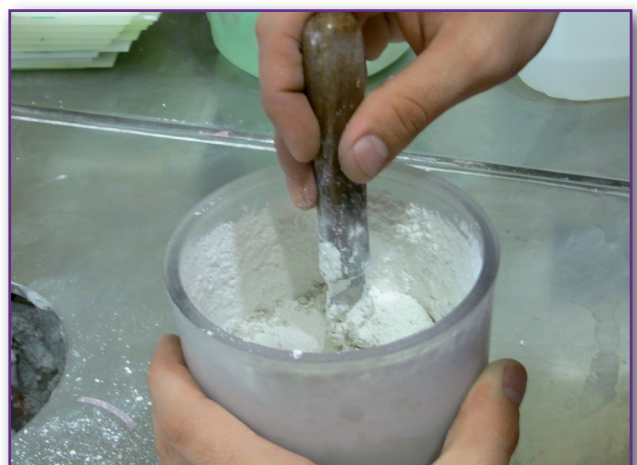
Figura 23. Proceso de preparación del revestimiento.
