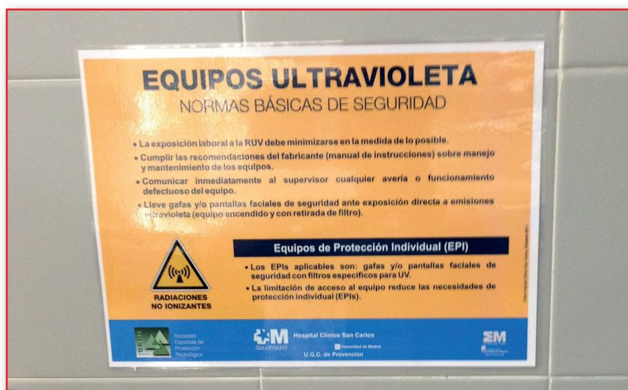
Figura 5. Cartel de normas básicas de seguridad de un equipo que usa luz ultravioleta.
