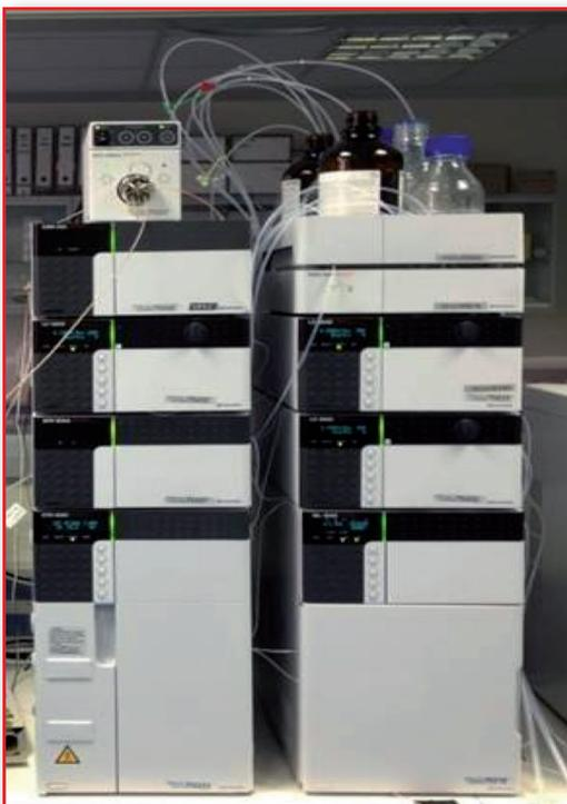
**Figura 24.** Cromatografía líquida de alta resolución (HPLC).
